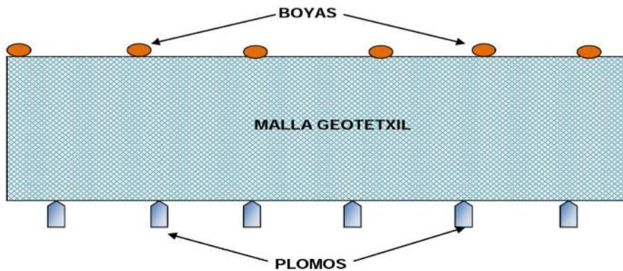
Figura 8. Diseño de instalación de mala geotextil
