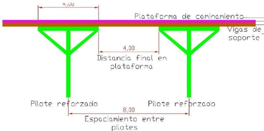
Figura 12. Diseño de los pilotes reforzados
