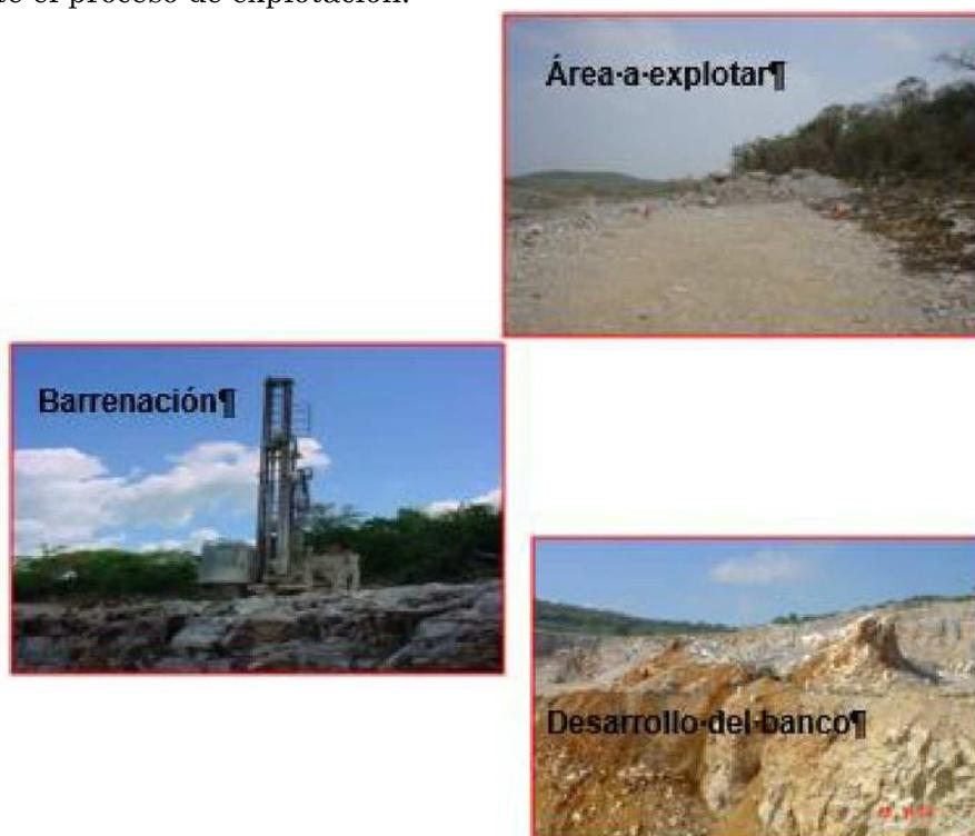
**Figura II. 18.** Pasos a seguir para la explotación de material pétreo.
