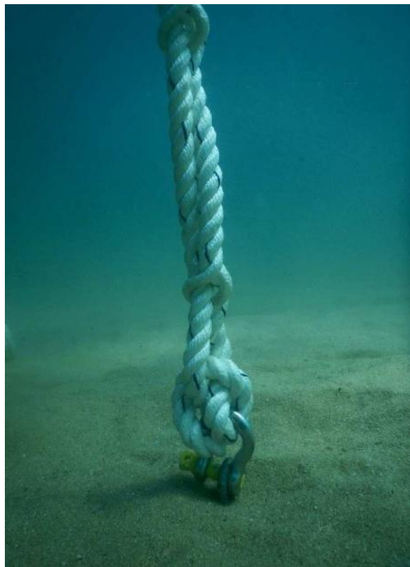
Figura 5.- Vista final de un anclaje manta raya, solo se ve el grillete de fijación.
