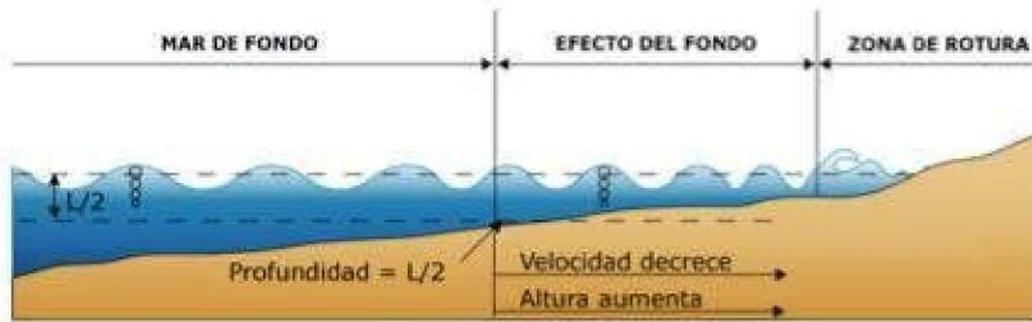
Figura 6-23. Esquema de la rotura del oleaje por fondo. La profundidad disminuye causando que la velocidad decrezca, la altura de la ola aumenta y rompe con la consecuente pérdida de energía.
