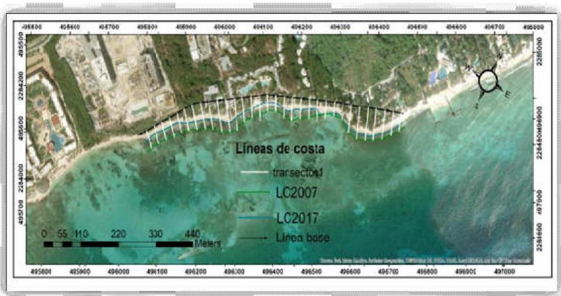
Esquema de elementos necesarios para realizar el análisis DSAS.
