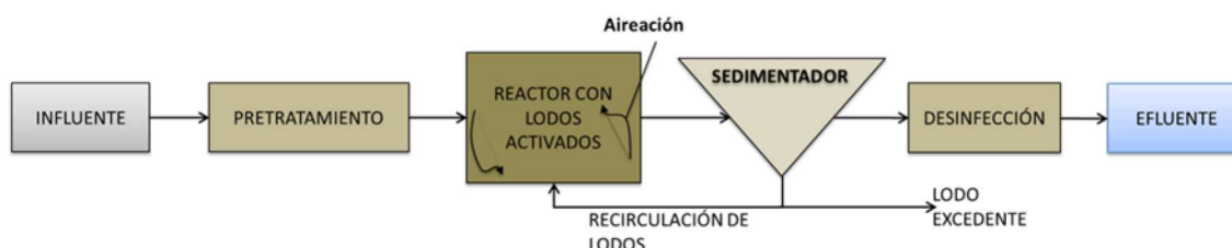
Figura N° 2 Diagrama de flujo de los procesos de la PTAR en el proyecto “Hotel Chukum”
