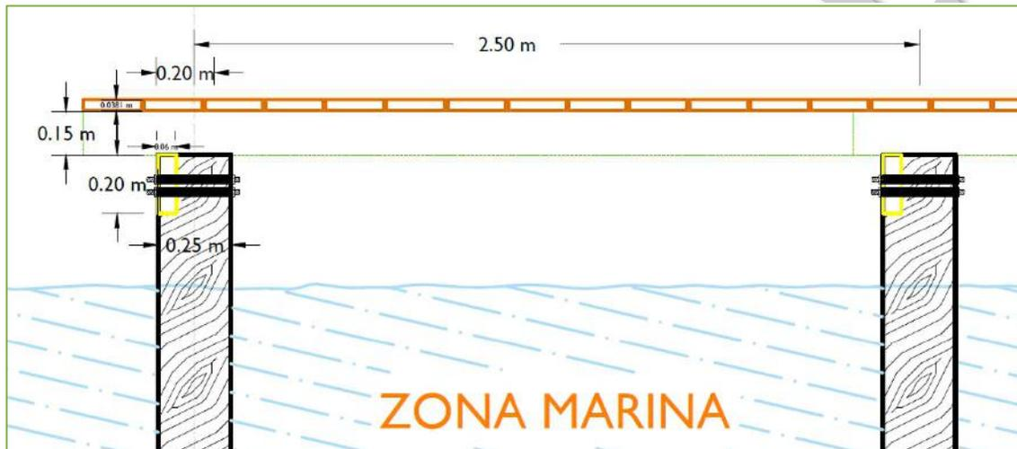
Ilustración 27. Indica el modelo base constructivo para el muelle, en las uniones de los rastreles y las vigas cargadoras.
