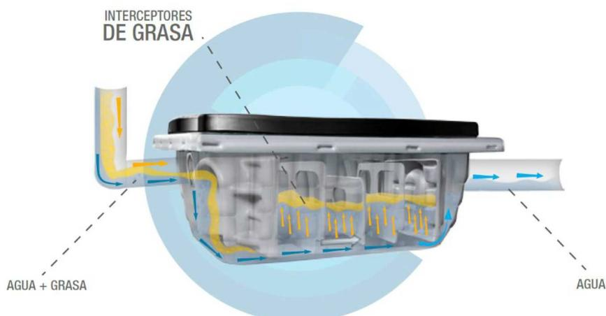
Interceptora de grasa con canastilla para sedimentos sólidos de 45 l/min y 18 kg de capacidad. Conexión para tubo de 2" para roscar. Modelo IG-20-PTM. (Ver ficha técnica)
