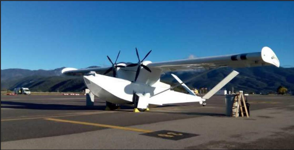
Figura No. 16 Dron modelo Flyox I, con control manual y a distancia.
