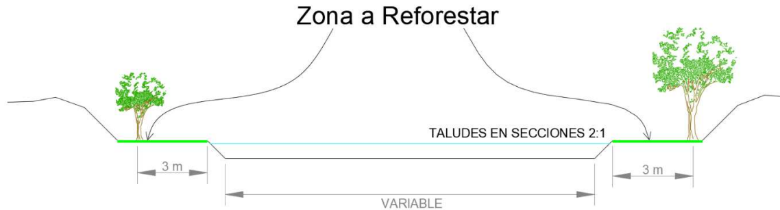
Imagen No. 10. Sección tipo del cauce con el proyecto finalizado.
