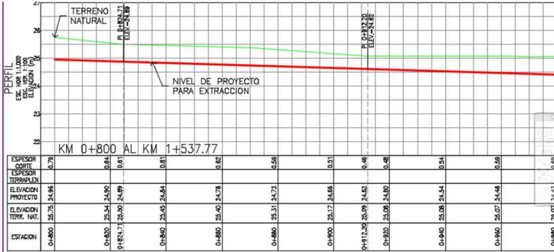
**FIGURA 7.- MUESTRA REPRESENTATIVA DE CORTE TRANSVERSAL, DE LA ESTACIÓN 1+320.000 A LA ESTACIÓN 1+537.77**
