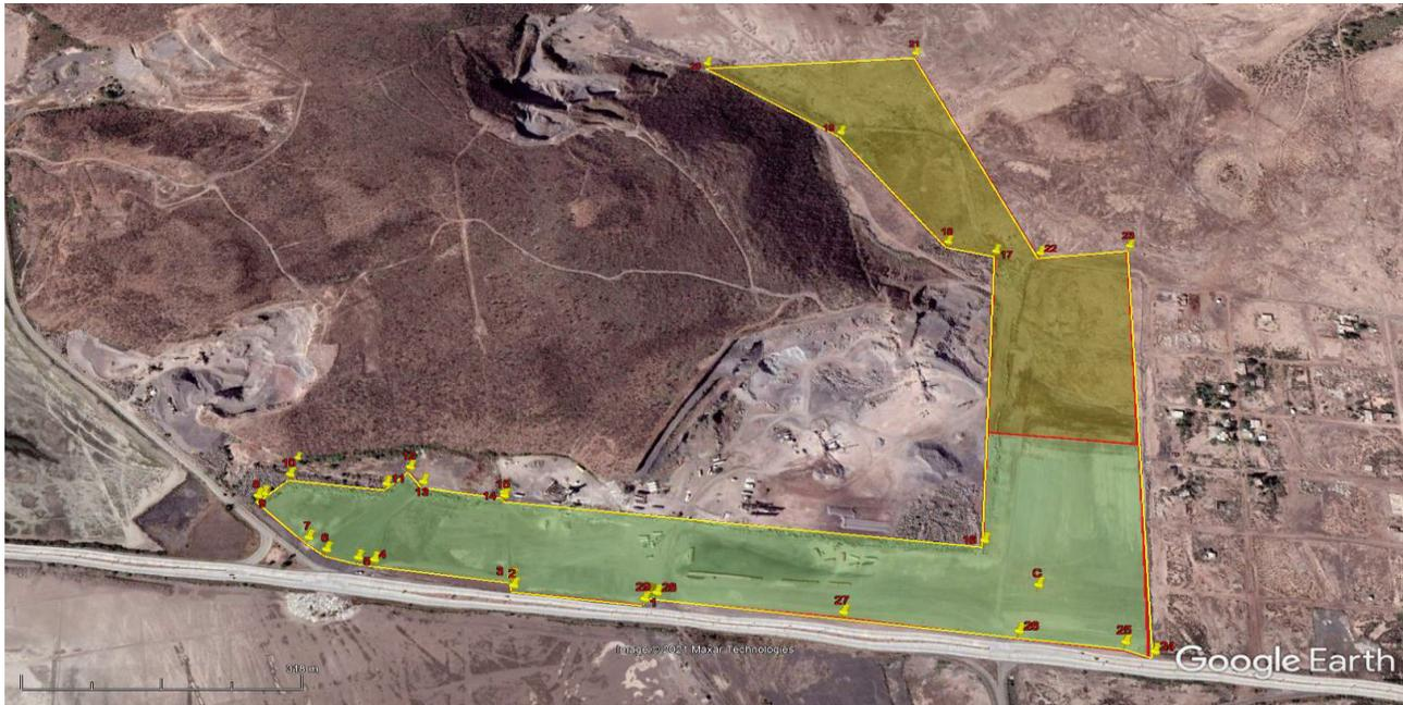
Figura 02. Imagen histórica del año 2020, se observan dos áreas: 1).- las que fueron rellenadas (2020) con material petreo (160,965.40 m<sup>3</sup>) verde claro, y 2).- las áreas sin relleno (139,850.96 m<sup>3</sup>) verde oscuro todas con áreas sin vegetación aparente como lo muestran los datos vectoriales del INEGI, 2005.
