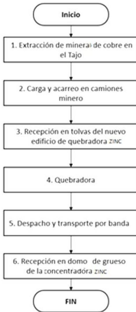
Figura II-13. Operación general en el Edificio de Trituración Primaria de Zinc
