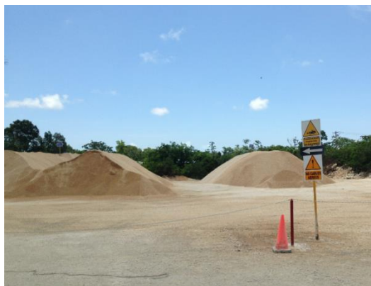
Figura II.8. Ejemplo del almacenamiento de los agregados.
