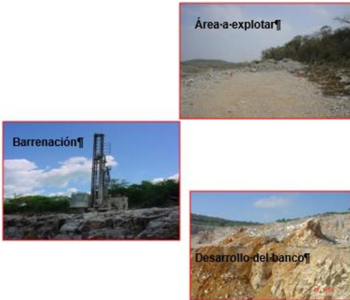
**Figura II. 8.** Pasos a seguir para la explotación del material pétreo.
