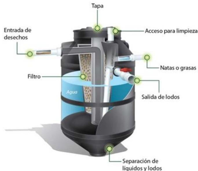
Figura II.4.- Esquema de los componentes del biodigestor propuesto para el manejo de las aguas residuales.
