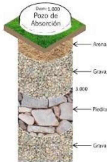
La disposición general del sistema se muestra en el siguiente esquema:
