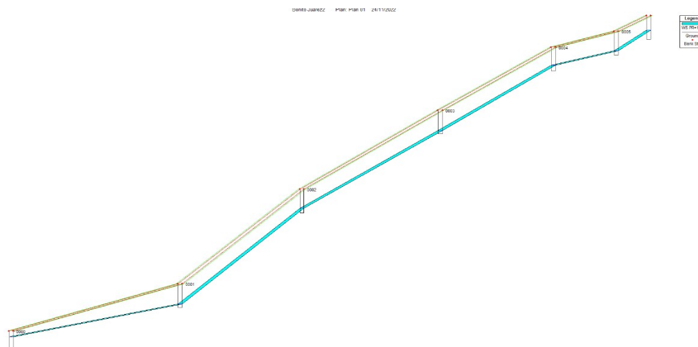
Ilustración26.- Perfil del trazo en 3D con las secciones y el tirante de agua que evacua el canal 2
