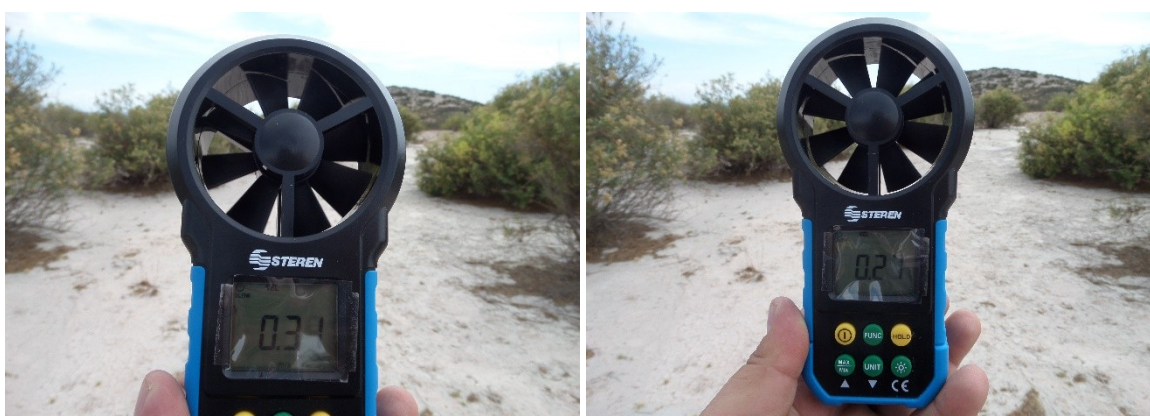
Ilustración 25.- Evaluación preliminar de la velocidad del viento
