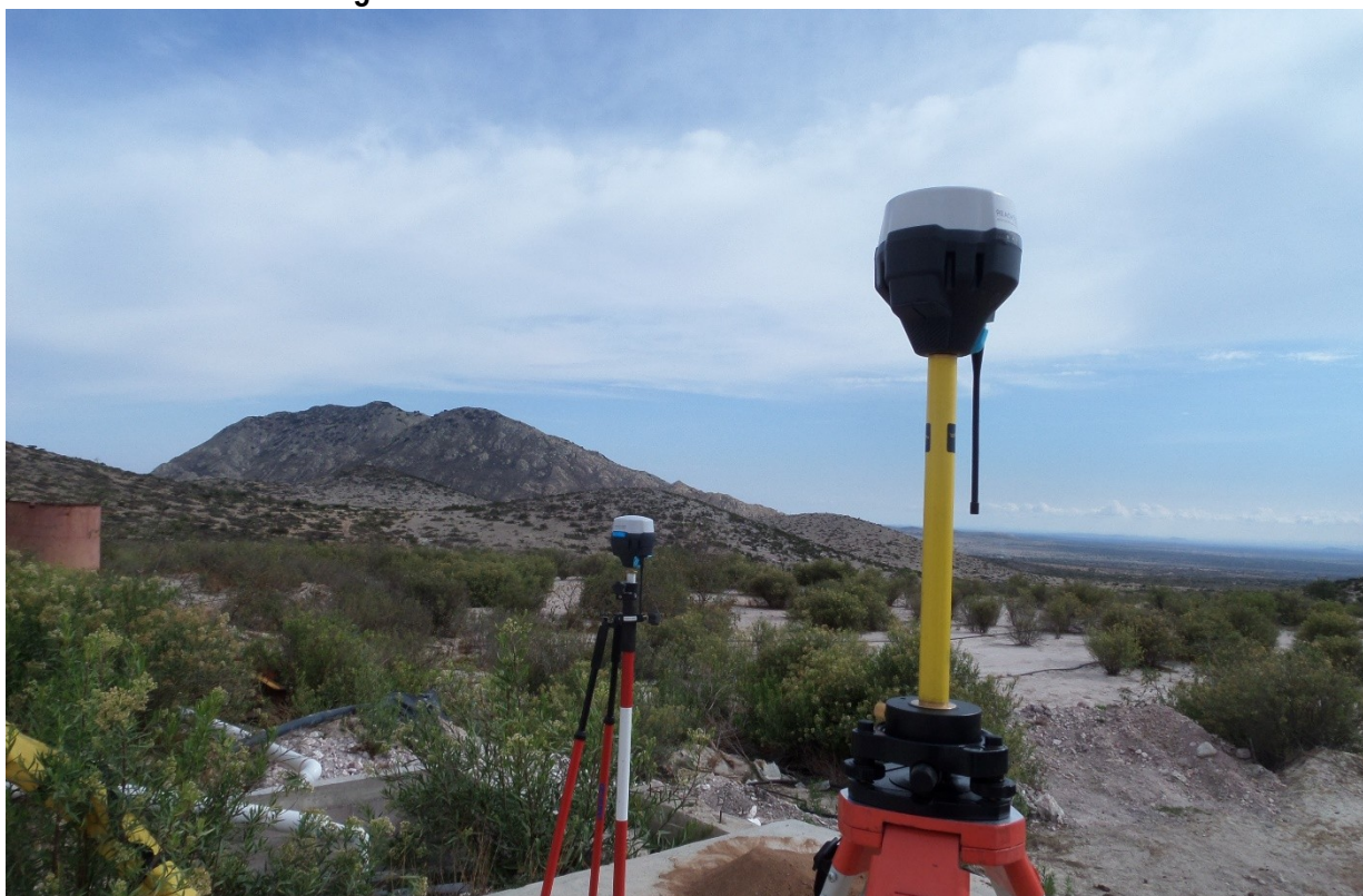
Ilustración 1.- Equipo utilizado para el levantamiento topográfico del sitio del proyecto
