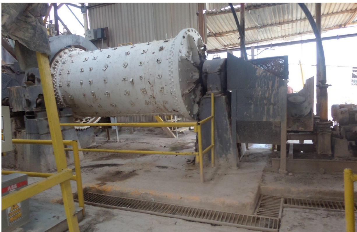
Ilustración 12.- área de trituración con molino de bolas
