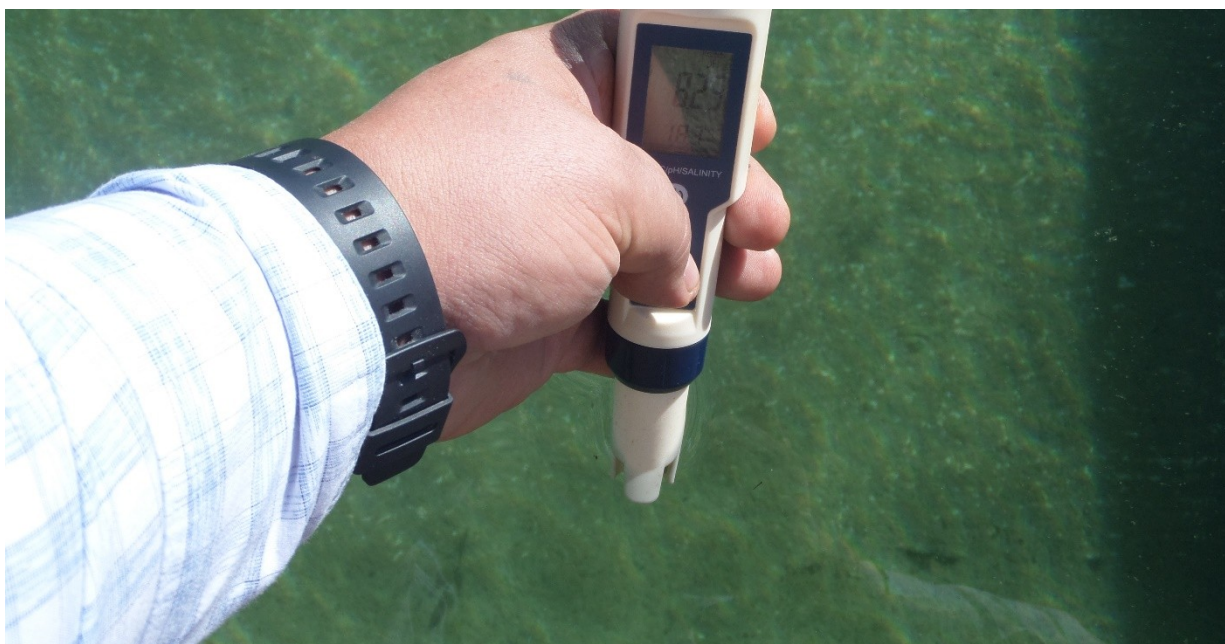
Ilustración 28.- Otros indicadores de calidad de agua como salinidad, conductividad eléctrica y sólidos disueltos.
