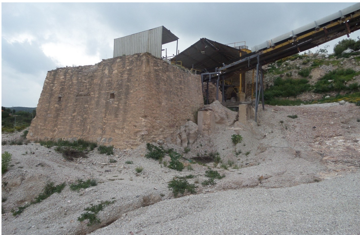
Ilustración 11.- Trituración primaria y secundaria con banda hacia área de molinos de bolas
