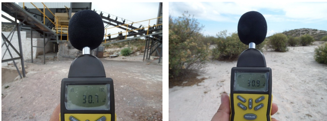
Ilustración 30. Decibeles recabados sin la operación de la planta que sirven como línea base.
