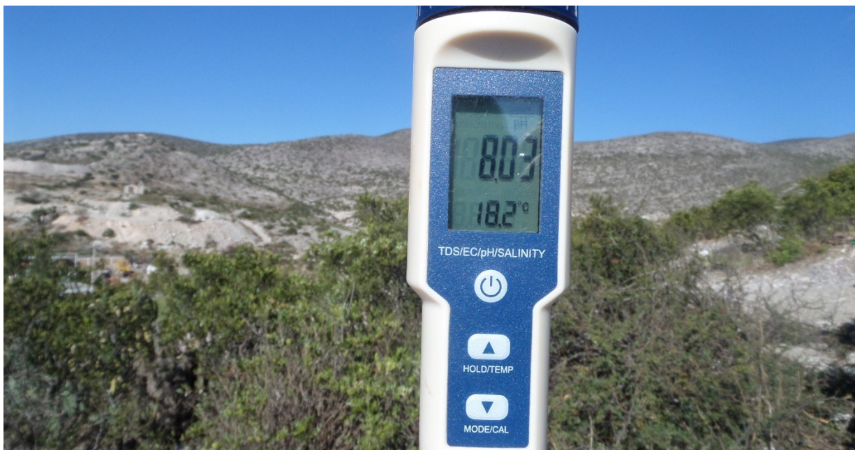
Ilustración 27.- Estimación del PH del agua con multímetro de bolsillo
