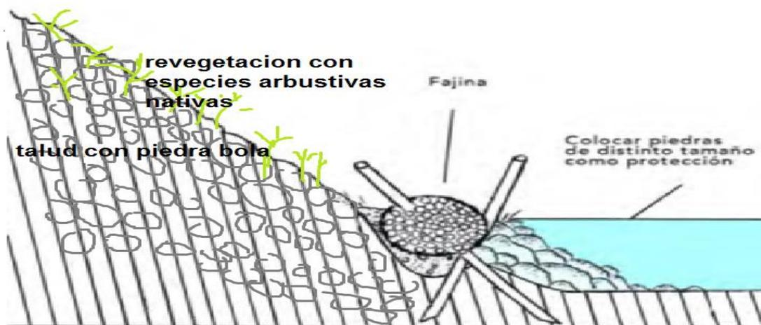
Figura 17.- **TALUD PROTEGIDO CON PIEDRA BOLA ACOMODADA Y REVEGETACIÓN**
