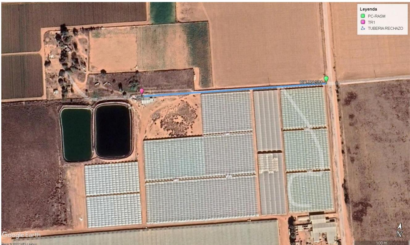
**Figura 4.** Imagen satelital que muestra la línea de la tubería del agua de rechazo desde la planta desaladora (TR1) hasta el punto de conexión con la tubería de la empresa
