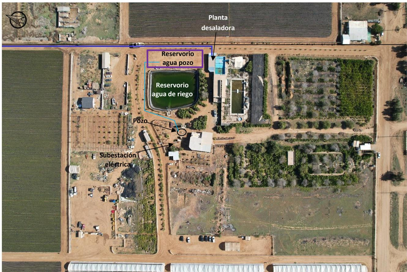
**Foto 1.** Fotografía aérea que muestra parte de la parcela 18 Z-1 P-1/4 (delimitado con línea negra), la planta desaladora y obras complementarias. La línea azul claro, representa la tubería del agua del pozo al reservorio y la línea azul marino representa parte de la tubería del agua de rechazo desde la desaladora.
