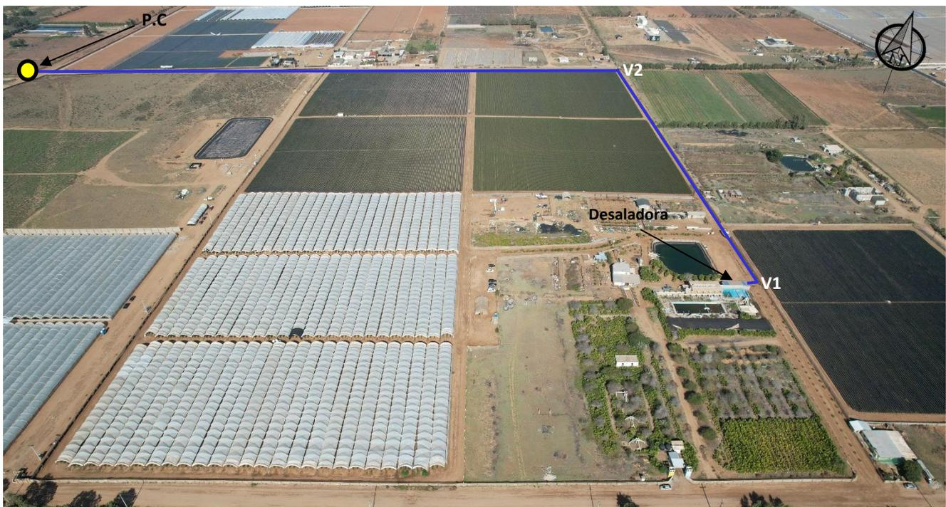
**Foto 6.** Fotografía aérea que muestra la línea de la tubería del agua de rechazo (color azul) desde la planta desaladora hasta el punto de conexión (círculo amarillo) con la tubería de SM Invernaderos S. de R.L. de C.V.
