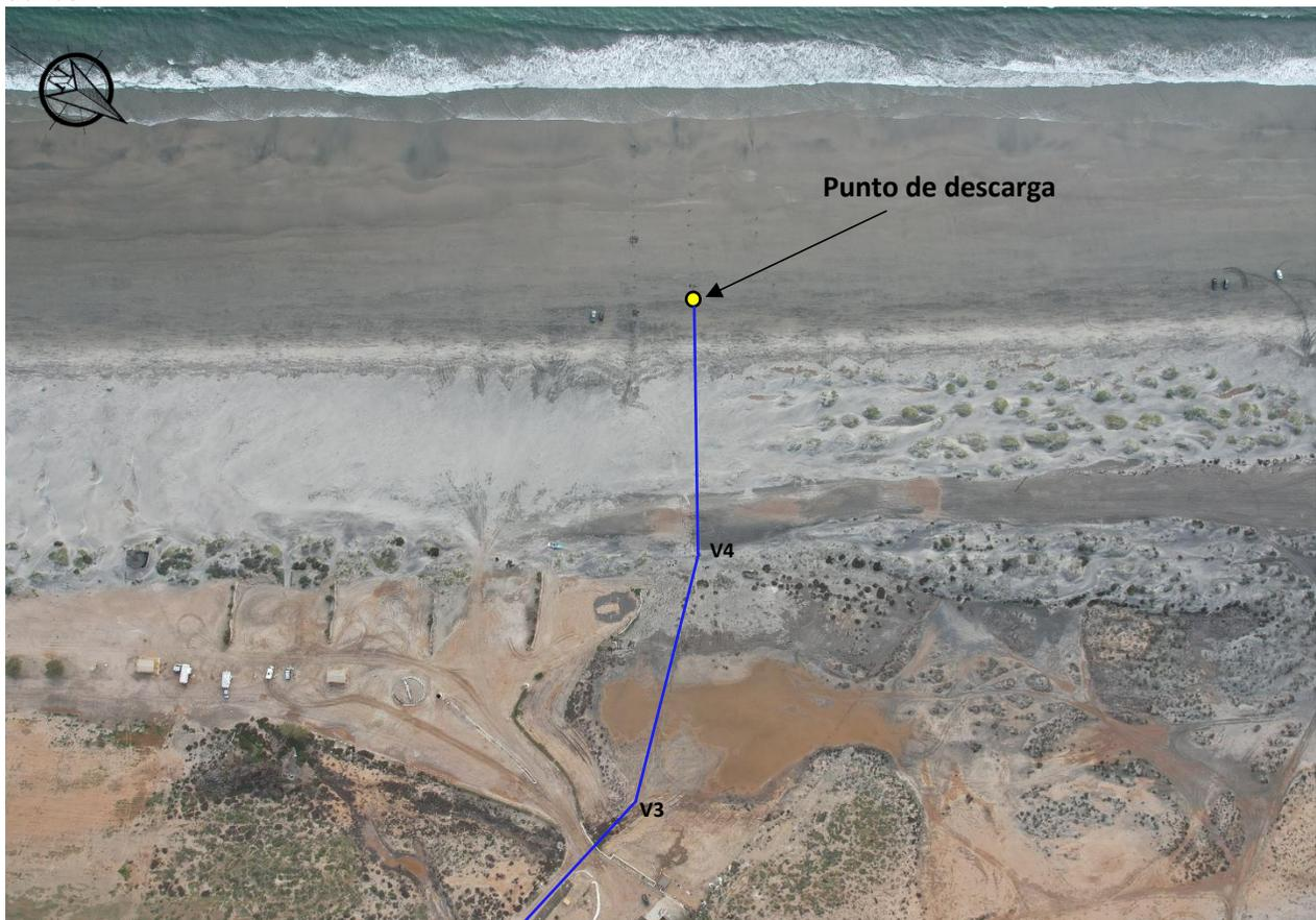
**Foto 12.** Vista aérea de la línea de conducción del agua de rechazo hacia el punto de descarga a través de la zona con vegetación natural.
