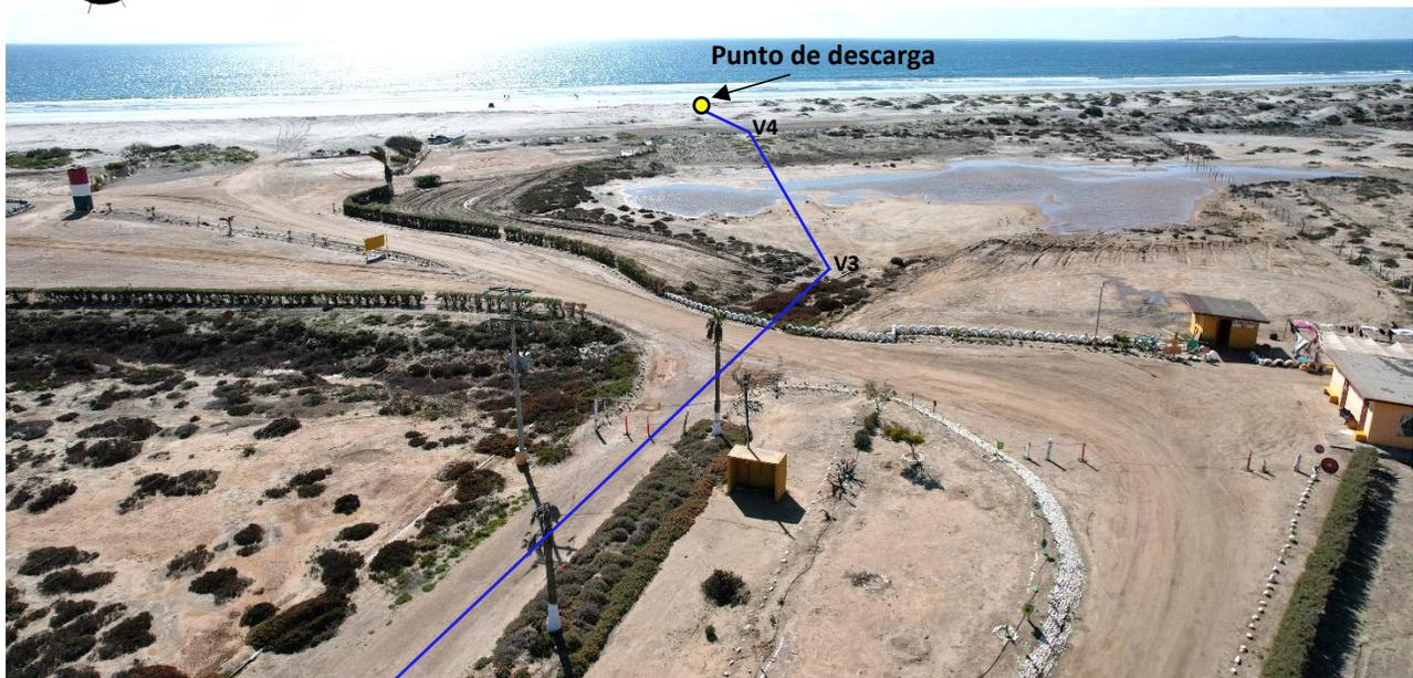
Foto 10. Continuación de la línea de conducción del agua de rechazo hacia el vértice 3, 4 dentro del predio parcela 7 polígono B del Ejido Nueva Odisea y posteriormente al punto de descarga. A partir del límite del camino de terracería la tubería recorrerá 240 m sobre el suelo para no modificar la morfología de la zona de dunas, ni dañar la vegetación natural existente.
