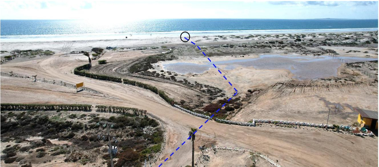
**Foto 17.** Vista de la zona costera donde el proyecto tendrá influencia directa. La descarga se propone en línea de costa y será necesario cruzar parte de una hondonada, 70 m de duna costera y 14 m de playa seca. El punto de descarga se encierra con un círculo negro y la línea punteada marca la ruta de la tubería.
