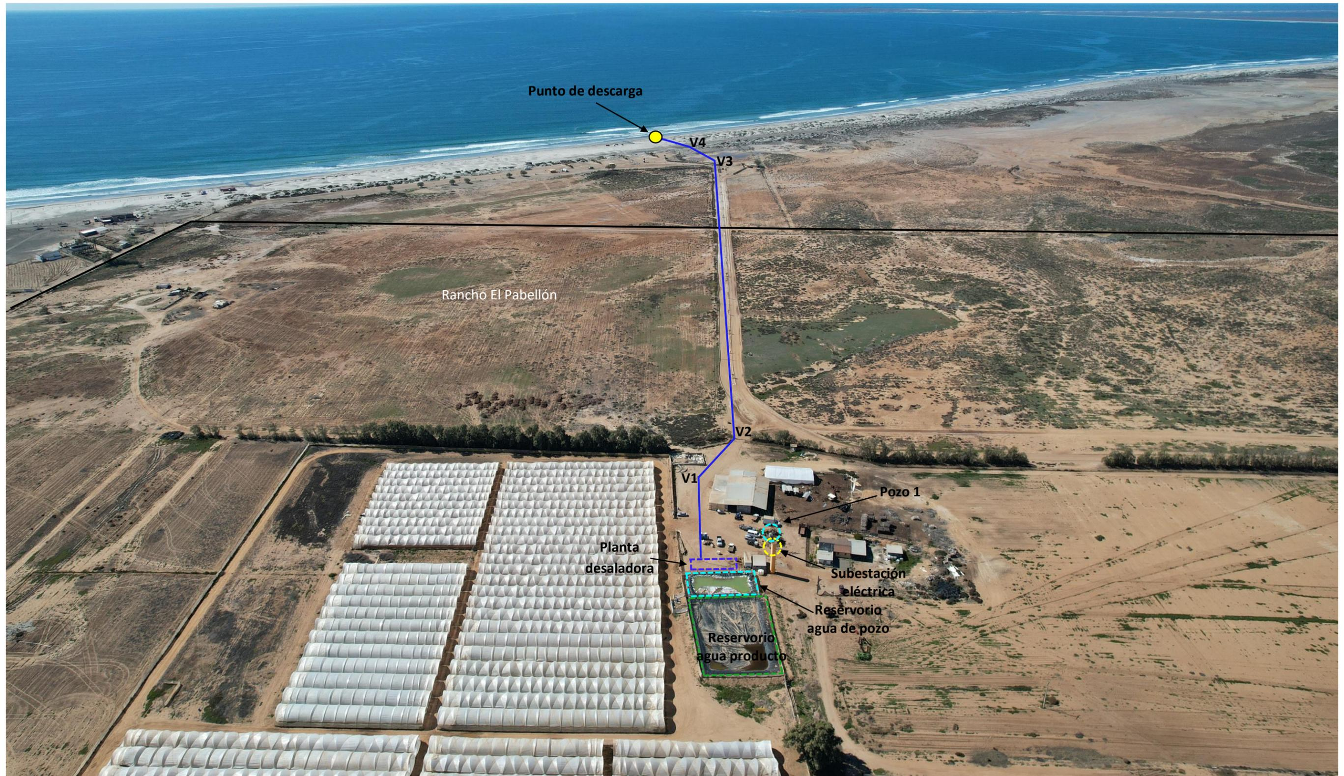
Foto 16. Imagen aérea de distribución de las obras que integran el proyecto. El Rancho El Pabellón se marca con la línea negra, la ruta de la tubería del agua de rechazo se representa de color azul hasta el punto de descarga en la playa El Pabellón.
