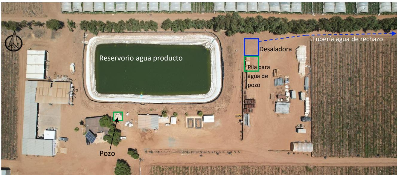
**Foto 2.** Vista del sitio donde se construirá la planta desaladora, la pila del agua de pozo sin tratar, la subestación eléctrica, y de las obras existentes que integran el proyecto como el reservorio para almacenar agua producto y el pozo agrícola.
