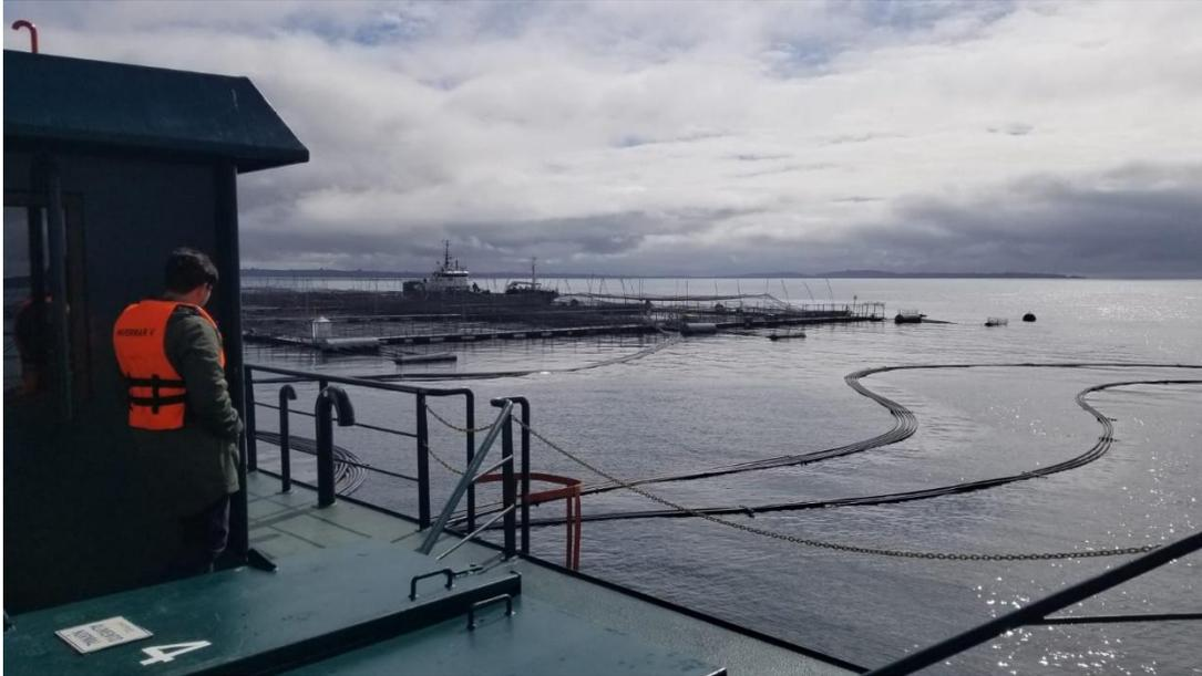
Imagen 2 Ejemplo de sistema de alimentación por mangueras de entrega de alimento a jaulas flotantes desde pontón de operaciones.
