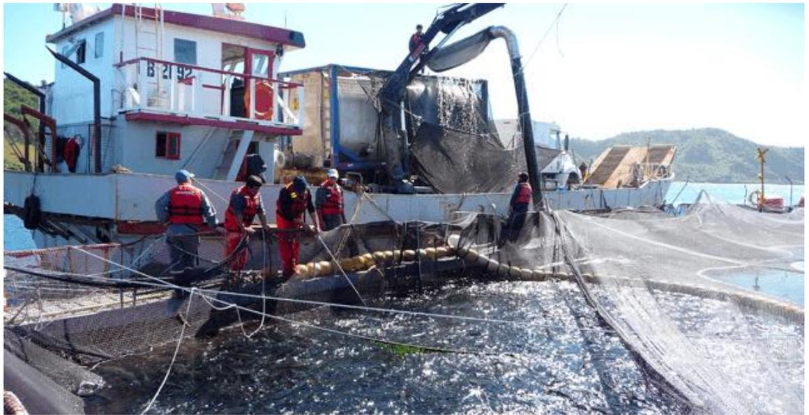
Imagen 4 Ejemplo de barcaza con bins a bordo hacia donde están siendo bombeados los peces y maniobra de acorralamiento de los peces realizada.
