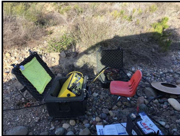
Foto 4. Equipo de resistividad automático utilizado en el levantamiento de datos.
