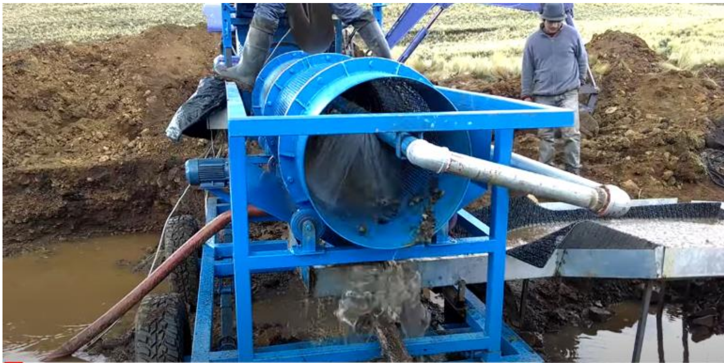
Imagen 2. Tromel procesando o lavando tierra para extracción de Oro. Para depósitos de placer.
