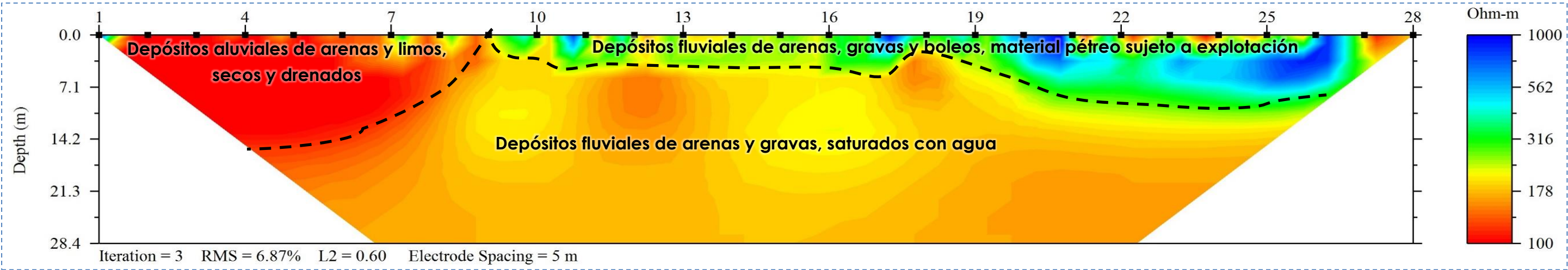
Figura 7. a) Localización del perfil de tomografía eléctrica L2; b) Modelo de distribución de resistividades (arriba) y c) su interpretación (abajo). Los números de la parte superior del modelo indican el número de electrodo a lo largo del perfil.
