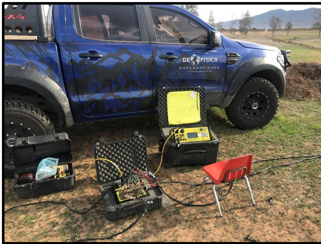
Foto 4. Equipo de resistividad automático utilizado en el levantamiento de datos.
