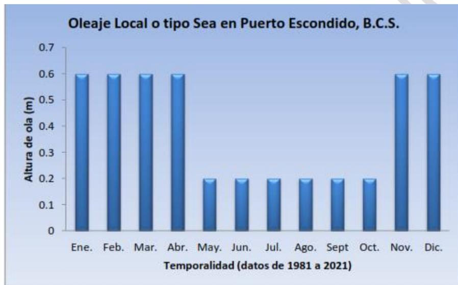
Figura 43. Altura significativa de ola que incide en Puerto Escondido.
