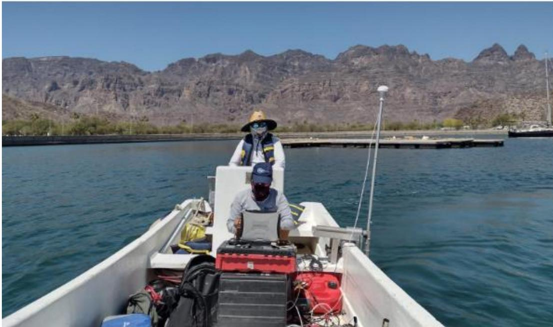
Figura 37. Sondeo con ecosonda en el área de la marina de Puerto Escondido.
