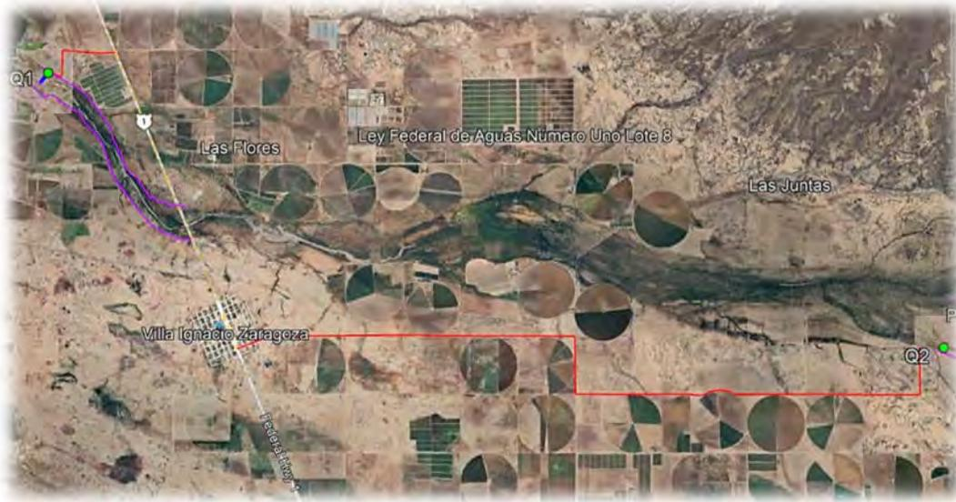
Figura II-32. Vías de acceso de terracería existentes (líneas rojas) hacia los dos bordos propuestos en el proyecto, que parten de la carretera pavimentada Cd. Insurgentes-La Purísima.
