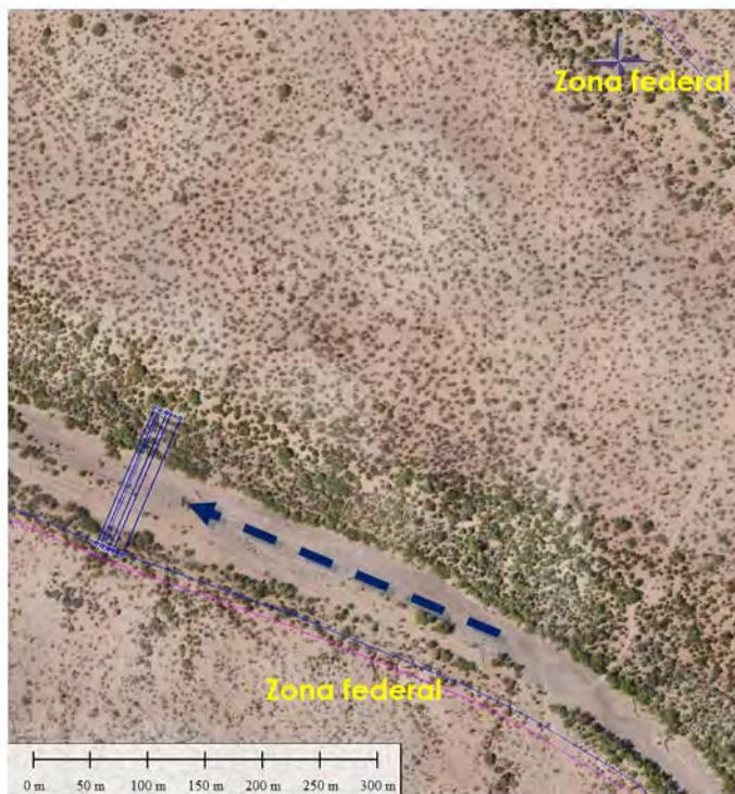
Figura II-12. Vista aérea del sitio propuesto para construir el bordo Q2. Líneas paralelas azul y fucsia al noreste y suroeste son la zona federal estimada, dirección de flujo en flecha azul. Fuente: imagen georreferenciada obtenida con dron, por IHF (2023).
