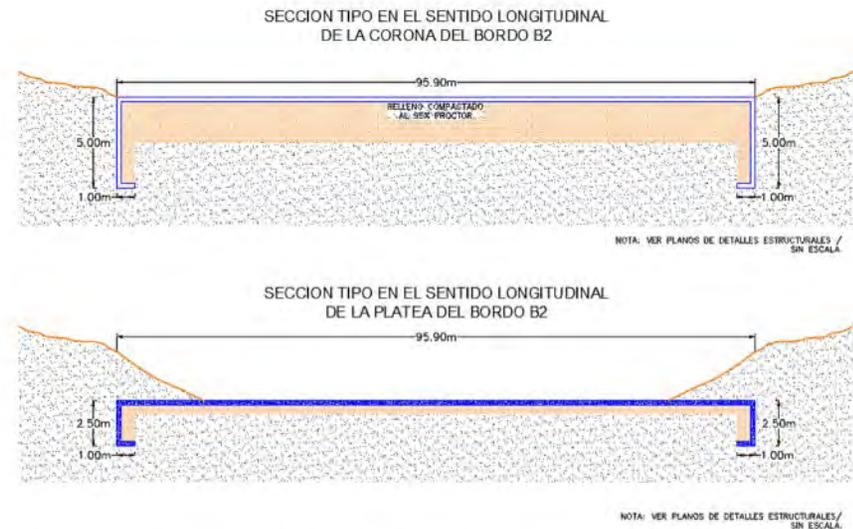
Figura II-39. El bordo B2 consta de una cortina de tierra compactada y revestida con una losa de concreto armado con acero formando un trapecio con una corona y sus dos taludes, una platea con su talud, y una geocelda, dentro del cauce y zona federal estimados, con superficie total de 3,303.76 m<sup>2</sup> (0.3303 ha).
