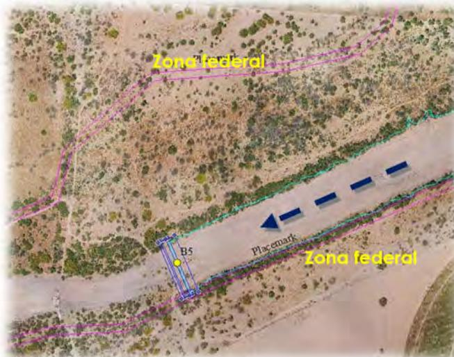
Figura II-27. El sitio del B5 se ubicará aguas arriba de un bordo antiguo destruido. Zona federal estimada en líneas fucsia, dirección de flujo en flecha azul. Fuente: IHF (2023a).
