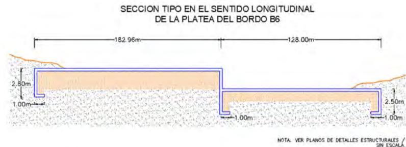
Figura II-43. El bordo B6 consta de una cortina de tierra compactada y revestida con una losa de concreto armado con acero formando un trapecio angular con una corona y sus dos taludes, una platea con su talud, y una geocelda en uno de sus lados, con superficie total de 8,508.72 m<sup>2</sup> (0.8508 ha).
