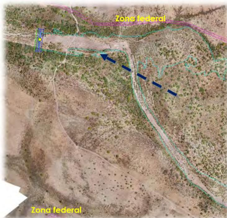
Figura II-19. Vista aérea del sitio propuesto para construir el bordo B1. Líneas paralelas fucsia al noreste y suroeste son la zona federal estimada, dirección de flujo en flecha azul. Fuente: IHF (2023d).
