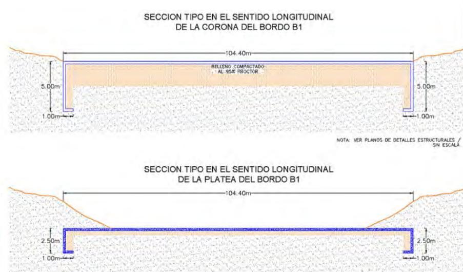
Figura II-38. El bordo B1 consta de una cortina de tierra compactada y revestida con una losa de concreto armado con acero formando un trapecio con una corona y sus dos taludes, y una platea con su talud, y una geocelda, dentro del cauce y zona federal estimados, con superficie total de 3,361.68 m<sup>2</sup> (0.3361 ha).
