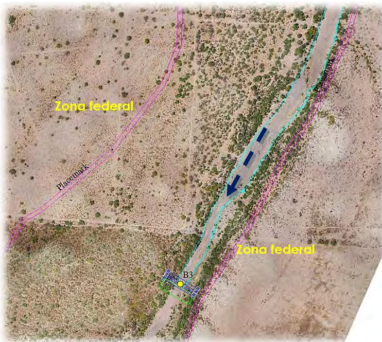
Figura II-23. Vista aérea del sitio propuesto para construir el bordo B3. Líneas paralelas fucsia al norte y sur son la zona federal estimada, dirección de flujo en flecha azul. Fuente: IHF (2023c).
