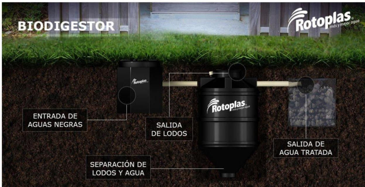
*Figura 15.- Biodigester de 7,000 lt para aguas negras y jabonosas*
