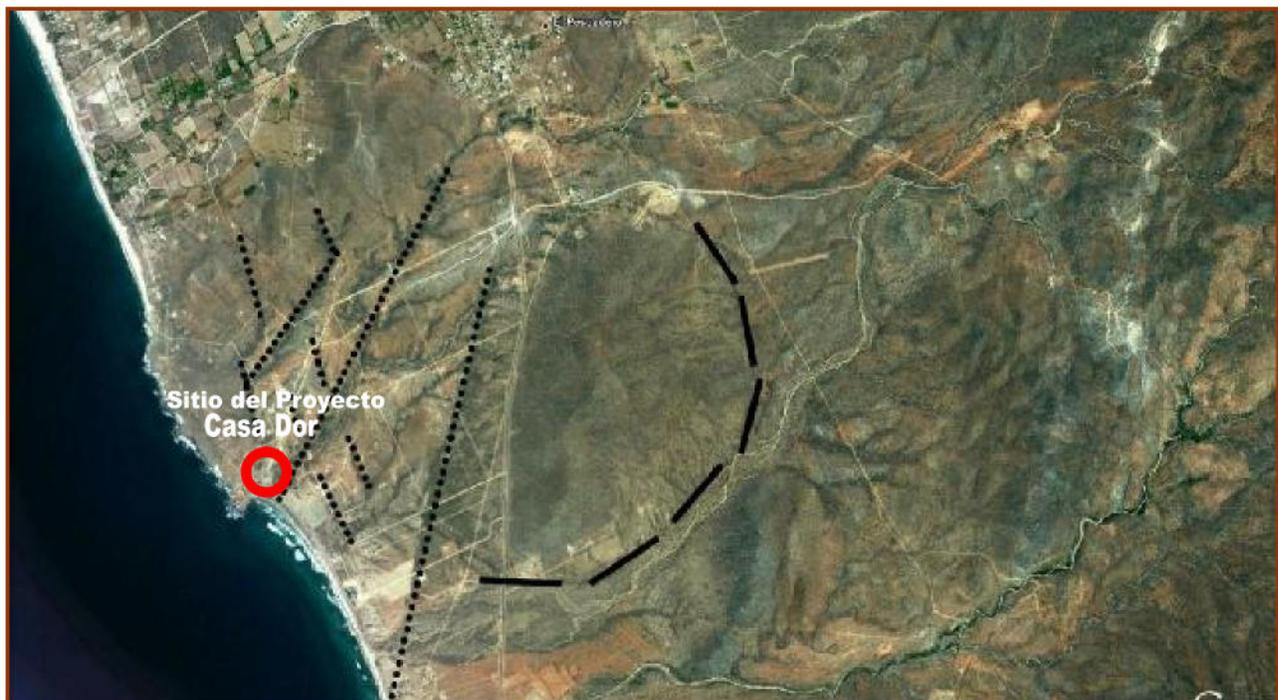
**Figura 15.-** En esta imagen de Google Earth se han sobre puesto las estructuras geológicas (fallas y alineamientos estructurales) cercanas al sitio del proyecto Casa Dor.
