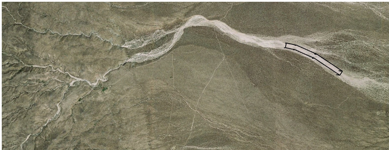
Figura 6.- El sitio del proyecto fue elegido por encontraren la fracción del cauce del arroyo con menor pendiente, la formación del cauce piloto podría también favorecer la infiltración de agua que por precipitación escurre por ahí.
