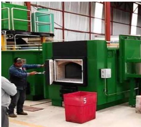
Figura II.7 Puerta de carga manual de la cámara primaria del Incinerador marca INCIMEX modelo UMCC-1T-RPBIs-250
