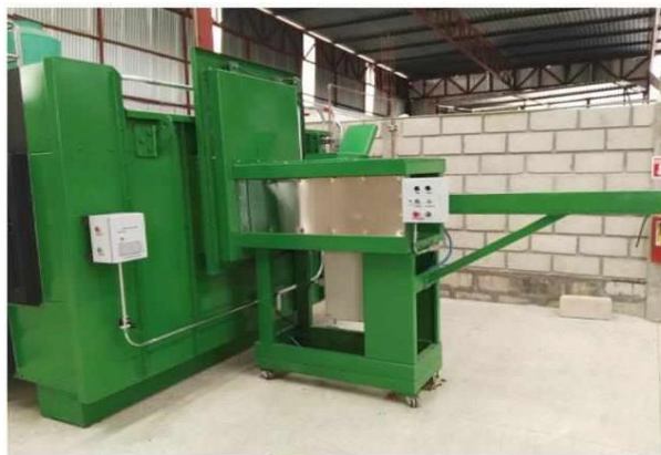
Figura II.8 Cargador automático de la cámara primaria del Incinerador marca INCIMEX modelo UMCC-1T-RPBIs-250
