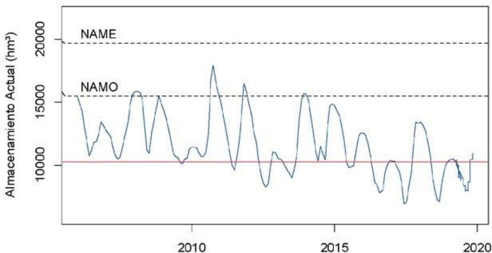
Fig. IV.2. Variación del almacenamiento de la presa La Angostura, Chiapas. La línea continua roja indica el promedio de almacenamiento.
