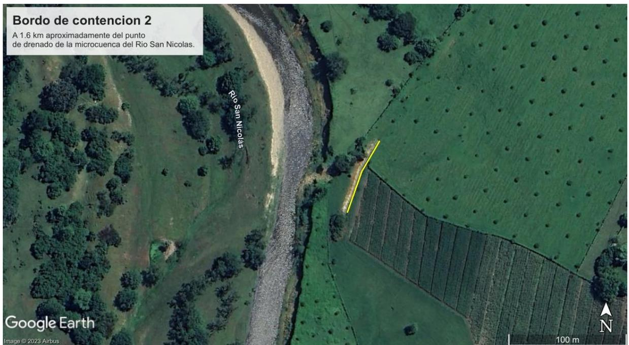
**Figura 4.19** Bordos de contención para evitar inundaciones en caso de avenidas fluviales fuertes o extremas en el Río San Nicolás, en el interior del SA.
