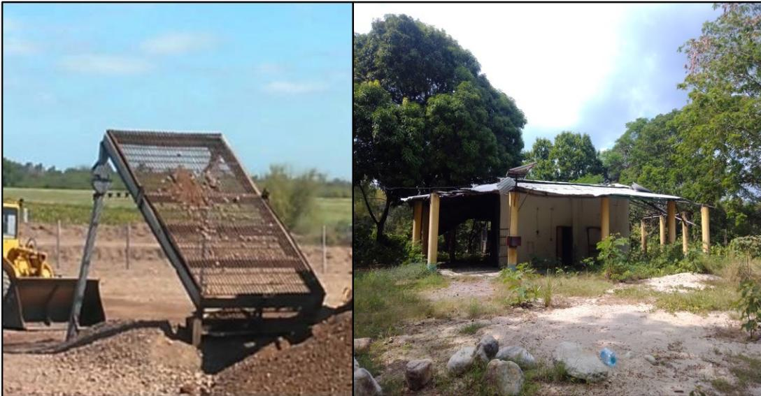
**Figura 2.5** En la imagen izquierda se aprecia una imagen representativa de una criba para separación de material, mientras que en la imagen izquierda se aprecia la vivienda existente que será aprovechada como zona administrativa y área de bodega.
