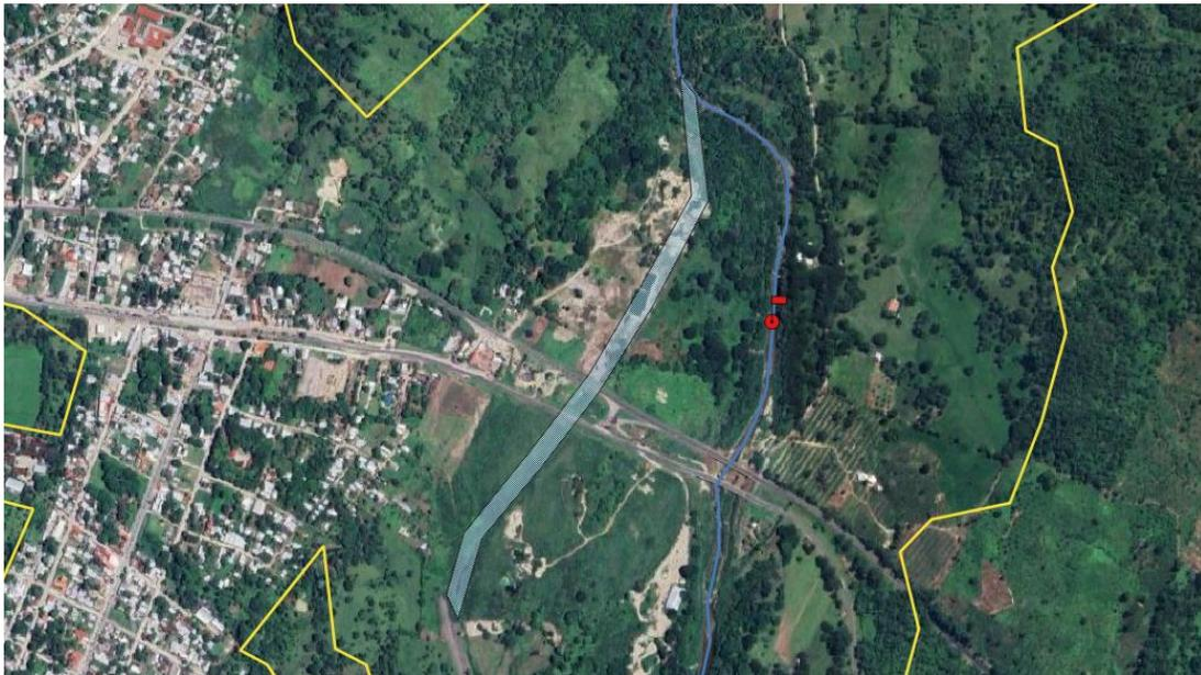
**Figura 4.14** En color azul claro se muestra la derivación que el Río San Nicolás (en color azul fuerte) presentó durante la ocurrencia de Stan. El banderín color rojo indica el sitio de extracción
