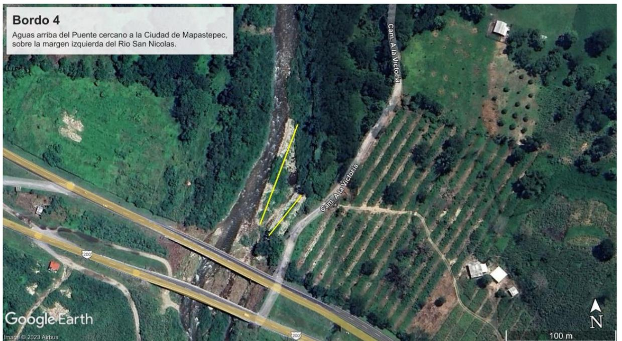
**Figura 4.20** Bordos de contención para evitar inundaciones en caso de avenidas fluviales fuertes o extremas en el Río San Nicolás, en el interior del SA.
