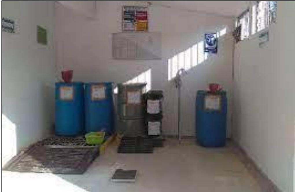
Figura 6.6 Ejemplo de adecuación de un espacio como almacén de RP (UAEH, 2022).
