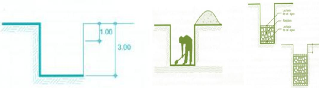
*Figura 7. Dimensiones de fosas de mortalidad y proceso de construcción.*
