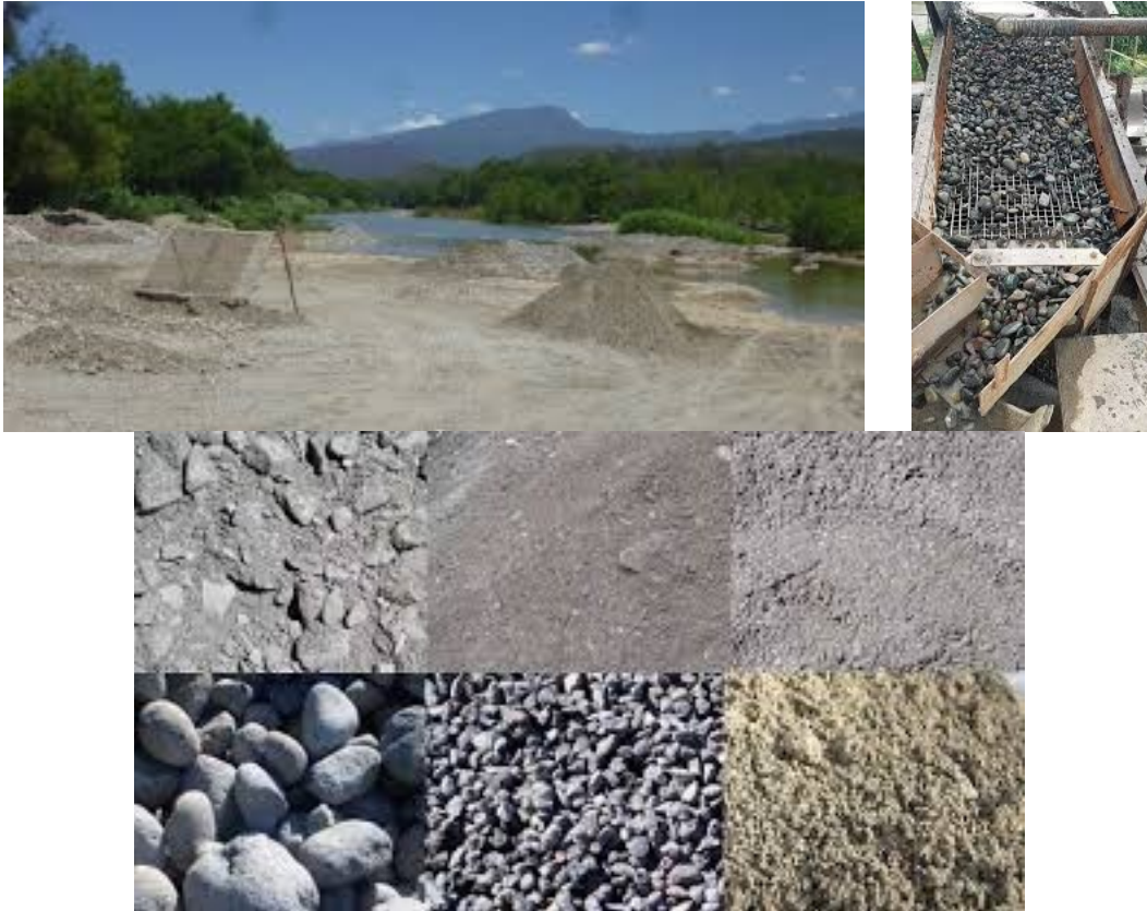
Figura 1.12. Imágenes descriptivas del cribado de los materiales pétreos del lecho del arroyo intermitente Chihuahua
