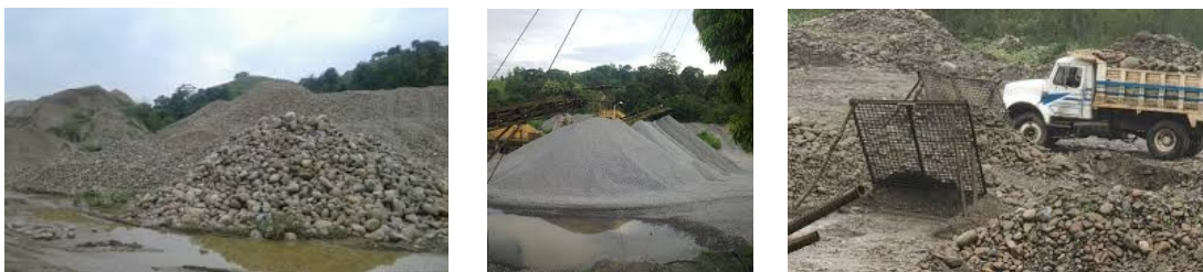
Figura 1.13. Imágenes descriptivas del almacenamiento del material pétreo ya cribado en el Banco de materiales PROINZAC
