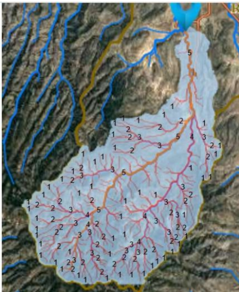
En la imagen anterior se aprecia la formación de los arroyos que se forman desde el parteaguas y que contribuyen a la conducción de caudales líquidos y sólidos a través de las precipitaciones que se presentan en cada evento. En cuanto a la ubicación del banco, se aprecia que se establecen en la zona denominada Delta, que se caracteriza por la disminución de pendientes y curvaturas en el cuerpo del cauce, lo que propicia a la colocación de las partículas trasladadas por suspensión, saltación o arrastre a través de la sinergia hidráulica ejercida.
