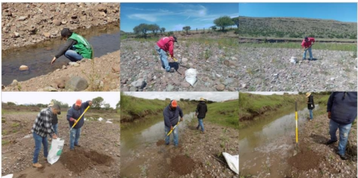
Figura Error: no se encontró el origen de la referencia-35. Excavaciones en el sitio para verificar profundidad y disponibilidad de material
