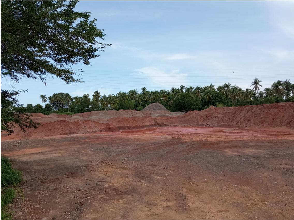
**Almacenamiento:** La almacenamiento del mineral se realizara utilizando camiones de volteo, el cargador frontal y retroexcavadoras. Se estima una capacidad de almacenamiento de 300,000 toneladas de mineral.
