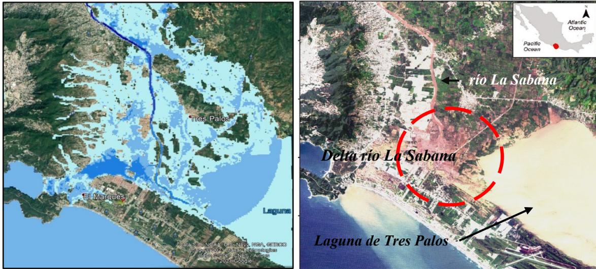
**Figura 15.** Principal área afectación por inundación, ante los fenómenos hidrometeorológicos de 2013 “Ingrid” y “Manuel”, en Acapulco Diamante (CENAPRED 2021; Pedrozo-Acuña *et al.* 2014).
