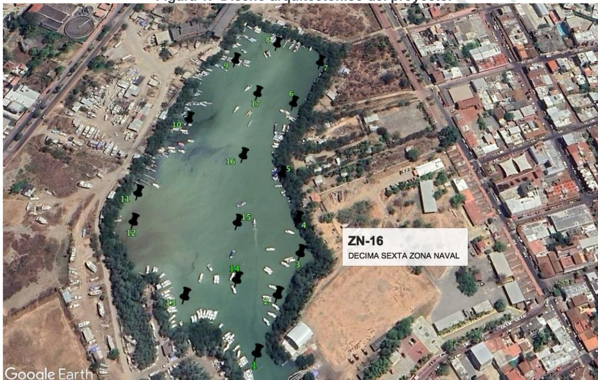
El proyecto contempla el dragado del canal y el cuerpo lagunar, con un volumen de material por extraer un volumen total de 22,227.62 m<sup>3</sup> y para la disposición de los residuos generados se ha programado su colocación en un relleno sanitario para lo cual se almacenarán y deshidratarán en una zona de tiro temporal con una superficie de 13,914.07 m<sup>2</sup> y capacidad de 27,834.08 m<sup>3</sup> suficiente si se considera un factor de abundamiento del material de 1.2.
