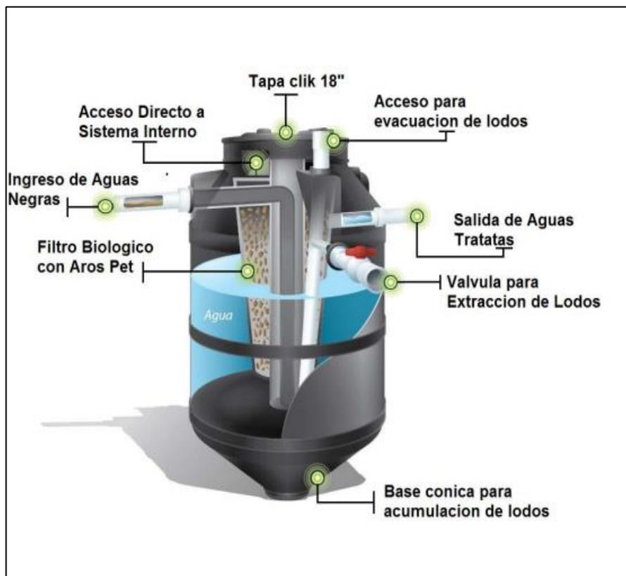
**Ilustración II.2.5.4. Descripción de Biodigestor Autolimpiable.**
