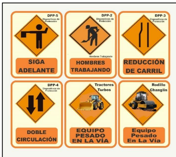
Ilustración II.2.11.1. Señalizaciones de hombres trabajando.
