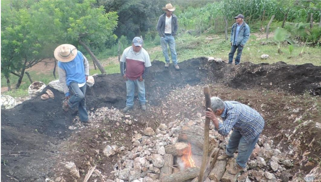
Figura 24. Encendido del horno y colocación de piedras.
