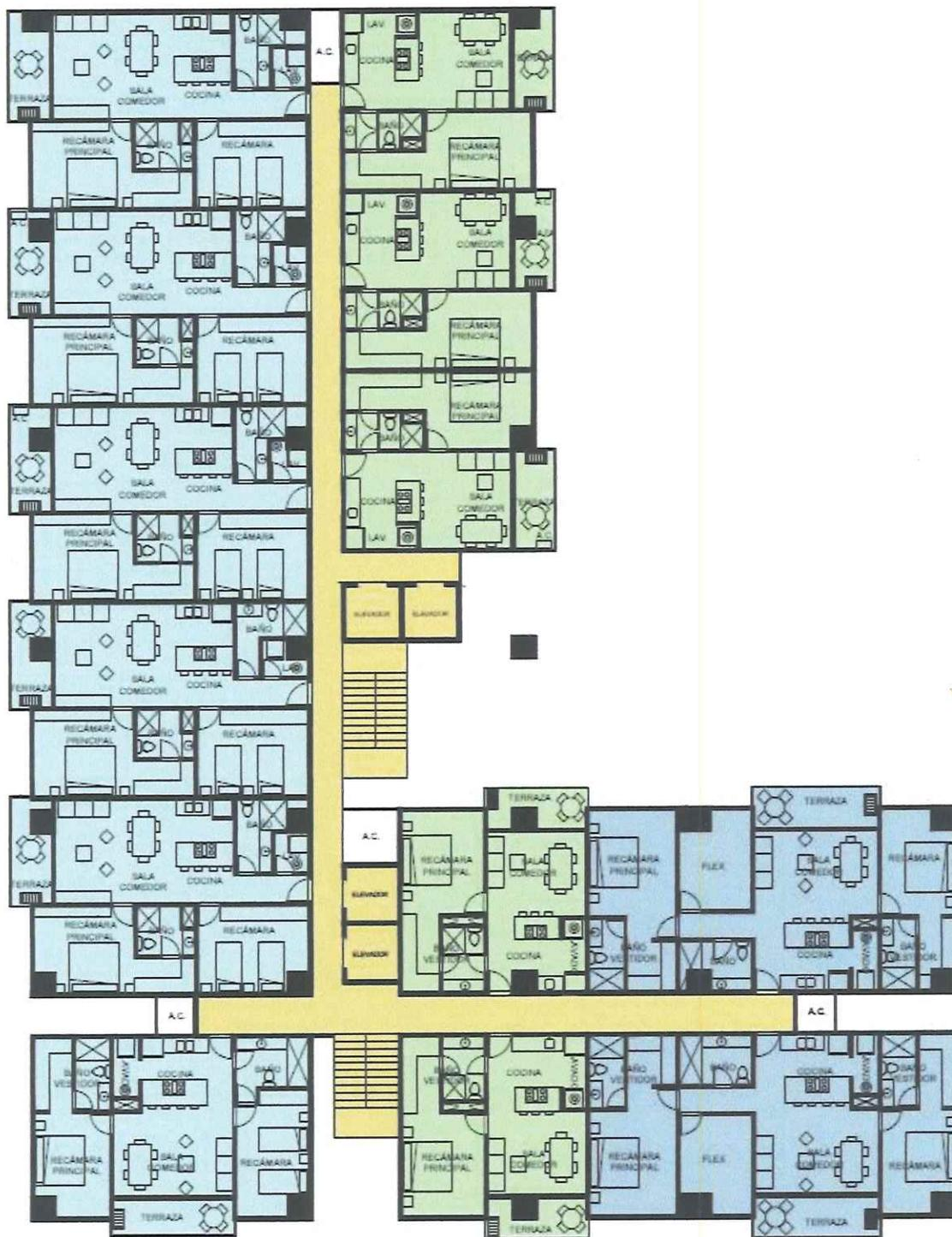
Figura Número 6.- Planta arquitectónica nivel 2 al 10, Fuente: Plano Arquitectónico.
