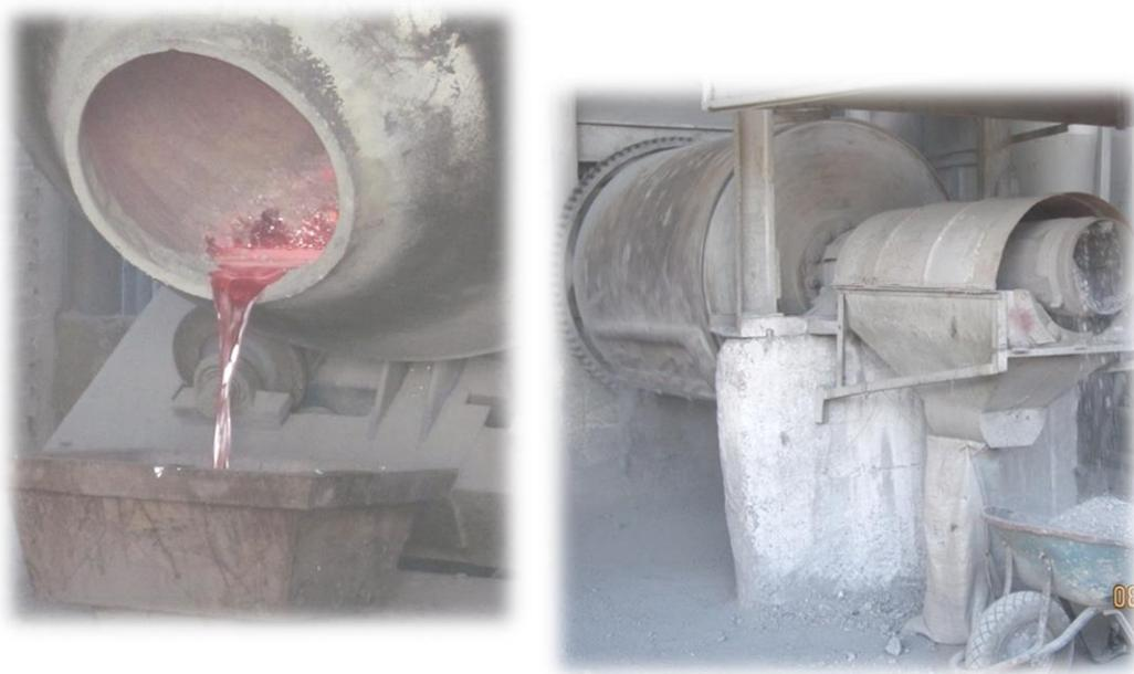
Vaciado de aluminio y molino de bolas.
