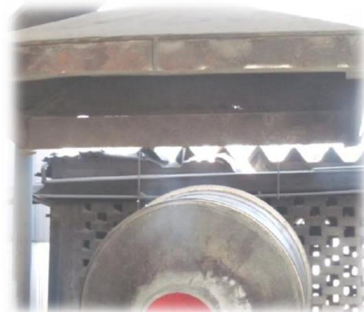
**6. Vaciado o lingoteo:** al terminar de fundir se apaga el quemador y se inclina el horno para sacarle la escoria que se encuentra en la parte superior del horno y que es colocada en un área temporalmente para que se enfrie y se reprocese (la escoria de la escoria se incorpora una última vez a los procesos 3, 4 y 5). Finalmente se coloca el molde del lingote bajo el horno para vaciar el metal líquido. Se genera oxido de aluminio, como subproducto del proceso.
