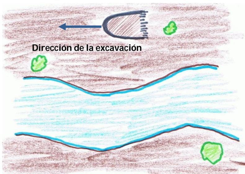
2. La excavación siguiendo la dirección del río se realizará de forma normal y el material extraído será retirado para su tratamiento; una vez que la excavación haya alcanzado una longitud entre los 20 y 30 metros deberá ser detenida, de igual forma se detendrá en caso de topar con algún mancho de vegetación arborea.
