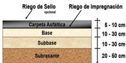
Cuando el material para subrasante sea producto de los cortes, se podrá transportar utilizando tractores o motoescrepas. Cuando el material para subrasante sea extraído de bancos o sea necesario almacenarlo para su posterior utilización en la obra, se tendrá cuidado en su transporte y almacenamiento, con el propósito de evitar la alteración de sus características, atendiendo los siguiente:
