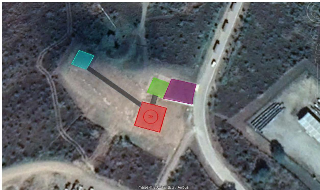
FIGURA 2.1: MUESTRA LOS COMPONENTES DEL PROYECTO (ROJO: PISTA PRINCIPAL, AZUL: PISTA 2, VERDE: PISTA 3; MORADO: ESTACIONAMIENTO VEHÍCULAR Y GRIS: CALLES DE RODAJE).
