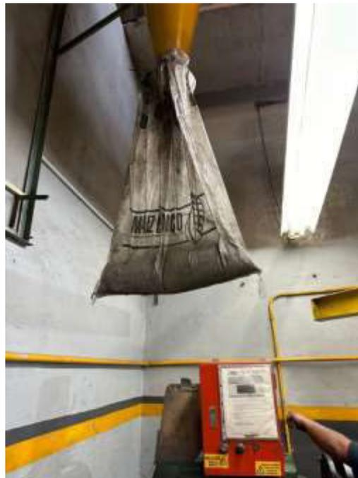
**Figura 55.** Bolsa de residuos del colector de polvos.
